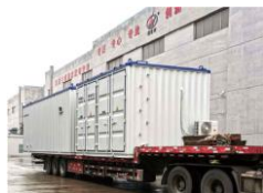
新疆天池移动变电站
