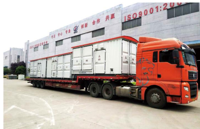
中融鑫尔康亚拖拽移动变电站预制舱
